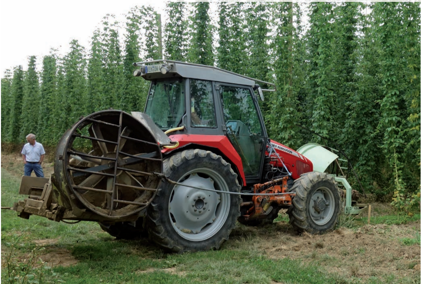
Mechanisches Hopfenputzen mit einem Laubsauger
