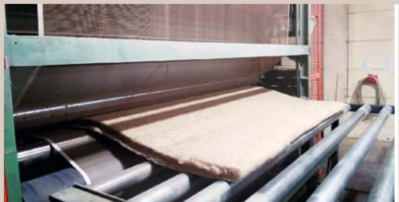
Thermisch verdichtete Dämmmatte Thermally compacted insulation mat
