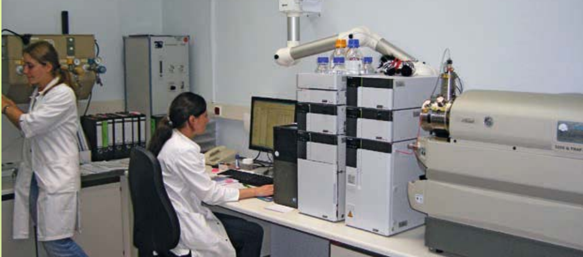
Massenspektrometer zur Rückstandsanalytik im Labor eines Hopfenverarbeitungswerkes Mass spectrometer for residue analysis in the laboratory of a hop processing plant
