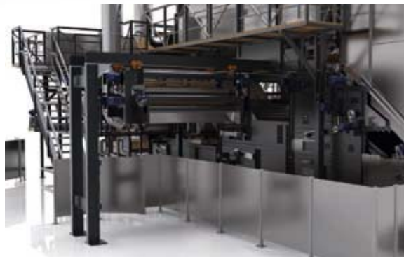
Ausgezogener Nachpflücker „STARPICKER SZ®“ “STARPICKER SZ®” subsequent picker removed for maintenance
